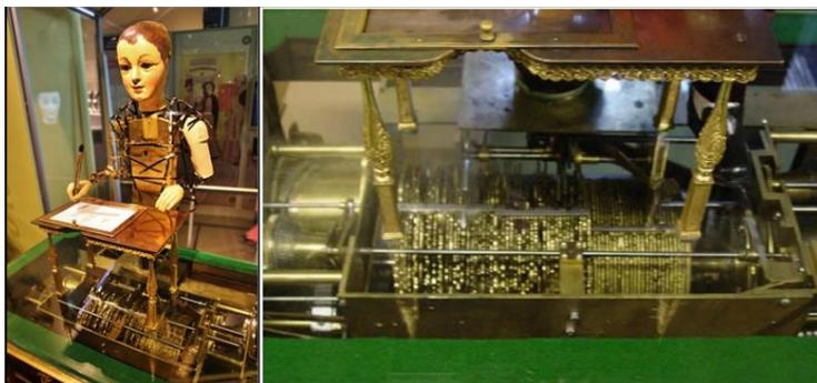
**Figura 33. Autómata diseñado por Maillardet y demostración de su sistema interno.**
