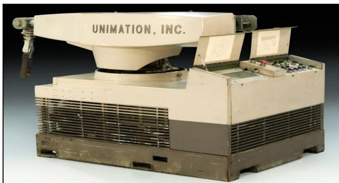
**Figura 48. Robot Unimate (el primer robot industrial del mundo)**
