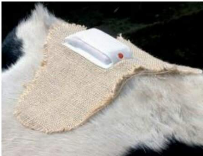
Figura 2.14: Vaca com detector de monta eletrônico (heat watch) colocado na garupa. Fonte: Acervo pessoal do autor.
