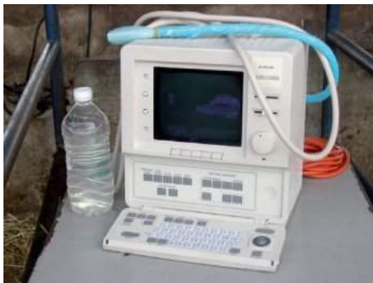
Figura 3.6: Equipamento de ultrassom com transdutor linear transretal de 7,5 MHz dentro de uma luva de palpação contendo gel. Fonte: Acervo pessoal do autor.
