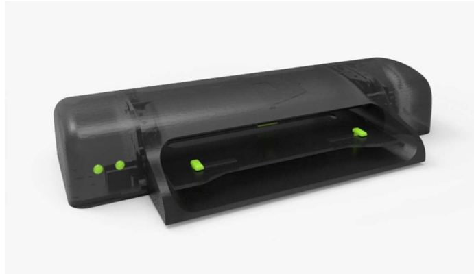
Figura 4. Impresora braille de bajo costo con componentes reciclados Figure 4. Low cost braille printer with recycled components
