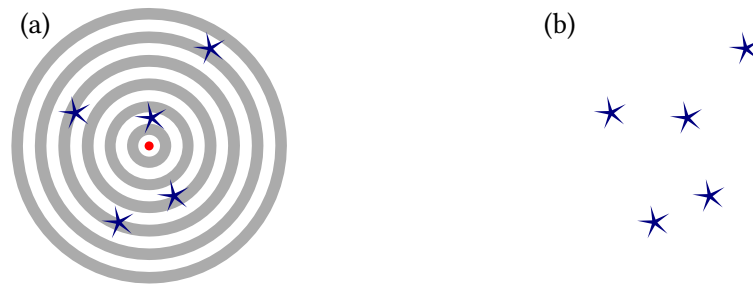
FIGURE 1.2 – Métaphore des cibles (figure a) : un mesurage est comparé à un exercice de tir sur une cible dont le centre (point central, en rouge) représente la « valeur vraie » du mesurande. L'éloignement des données expérimentales (représentées par les croix, en bleu) au centre de la cible représente l'erreur de mesure. Cette métaphore n'est toutefois pas parfaite. Une difficulté de cette métaphore réside dans le fait que, puisque la cible est représentée à un endroit précis, cela peut donner l'impression que l'expérimentateur connaît la valeur vraie, et qu'il peut alors déterminer grâce à cela les erreurs commises. Or, le problème est en fait l'inverse : on cherche à déterminer la position du centre de la cible à partir de celles des données expérimentales, et l'expérimentateur doit pour cela évaluer l'erreur commise. La situation qui apparaît à l'expérimentateur correspond donc à la représentation de la figure (b) plutôt qu'à celle de la figure (a).
