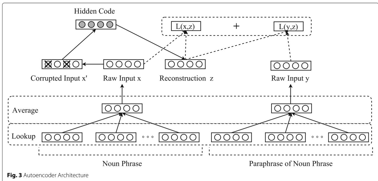
**Fig. 3** Autoencoder Architecture
