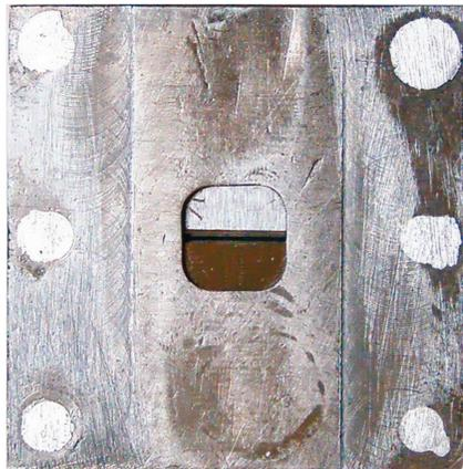
**Abb. 3. Spaltdia.** Zwei scharfgeschliffene Eisenplatten lassen in der Mitte des Dias einen horizontalen Spalt von 0,21 mm frei. (Ingo Nussbaumer, Moritz Foessel, Wolfgang Gratzl, 2010, Eisen 5 x 5 cm).
