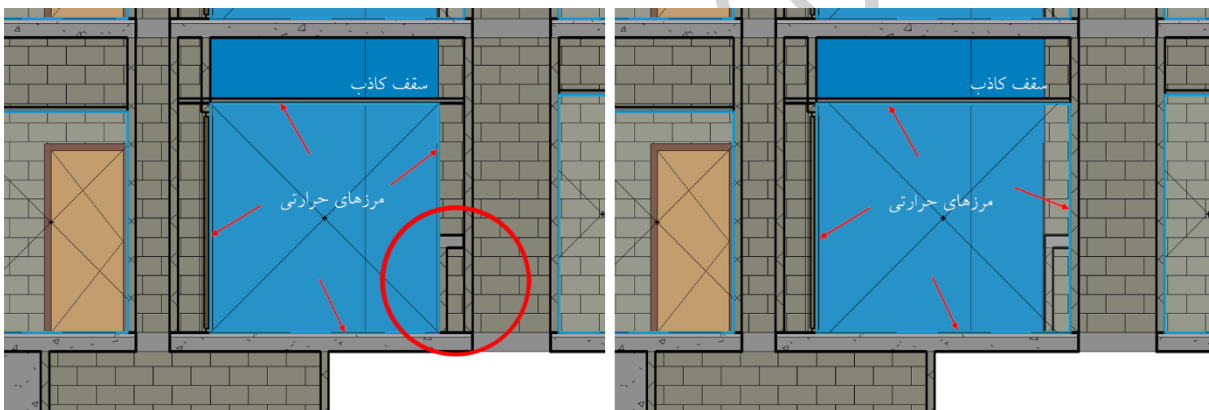
شکل ۴-۳۱- نمایش مرزهای منطقه حرارتی نادرست (سمت چپ) و مرزهای حرارتی صحیح (سمت راست).
