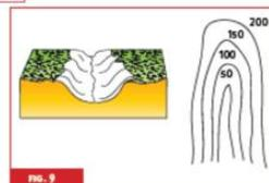
Observe que as curvas de nível são obtidas pela intersecção do relevo com planos paralelos que mantêm a mesma distância entre si. Essas intersecções, projetadas ortogonalmente sobre um plano, determinam as curvas de nível, conforme indicado na figura abaixo.
