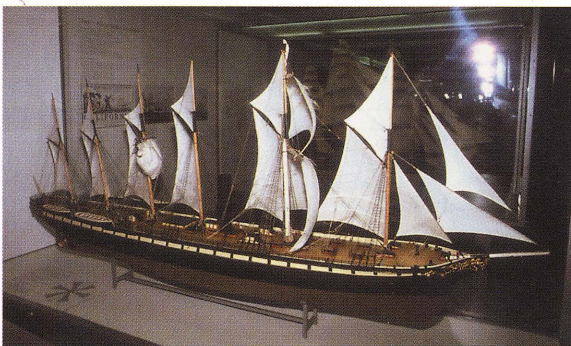
Abb. 3 Der Ozeandampfer »Great Britain« (1843), erste Kombination von Dampfmaschine, eisernem Schiffskörper und Schiffschraubenantrieb. Dies zeigt, wie die Realisierung des Prinzips »Dampfschiff« die Voraussetzungen nicht nur für quantitative, sondern auch für weitere qualitative innovative Entwicklungen von großer Tragweite bot. Modell im Deutschen Museum München, Aufnahme W. GIERER.
