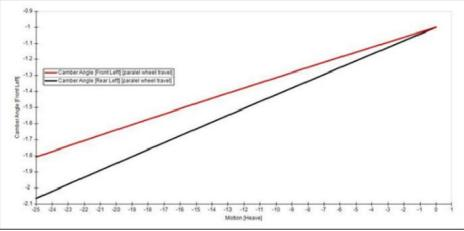
Fig. 8. Camber angle (v.s) Heave Motion
