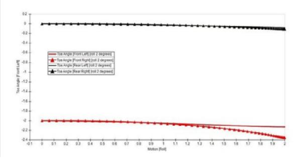
Fig. 15. Toe angle (v.s) Roll motion
