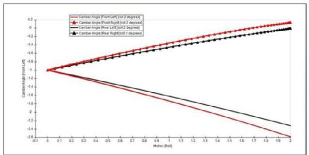
Fig. 12. Camber angle (v.s) Roll motion
