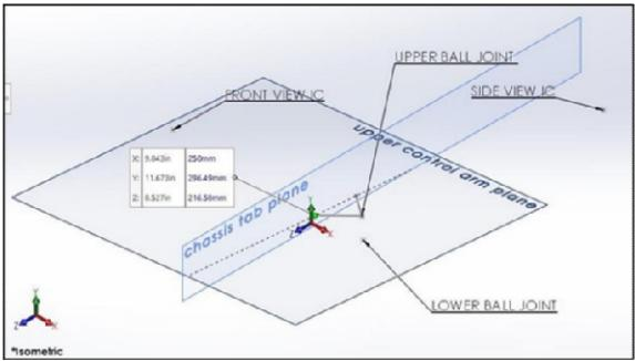
Fig. 6. A-arm line diagrams
