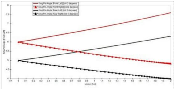
Fig. 14. Kingpin angle (v.s) Roll motion
