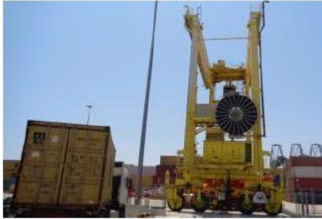
Figura 18. Grúa Electrificada en MSC Terminal Valencia con el Sistema Cable Reel
